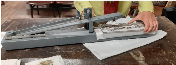
Resim 3.27. Sürtme bezinin ve baskılı kumaşın cihaza yerleştirilmesi ve testin uygulanması
