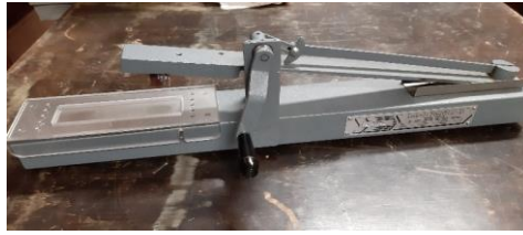
Resim 3.26. (sağda) Sürtünme haslık cihazı (crockmeter)
