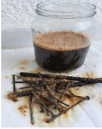
Resim 3.8. (solda) Demir çözeltilisinin hazırlanması
