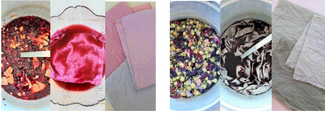
Resim 3.22. (solda) Kumaşların hibiskus/soğan kabuğu ekstraktı ile boyanması
