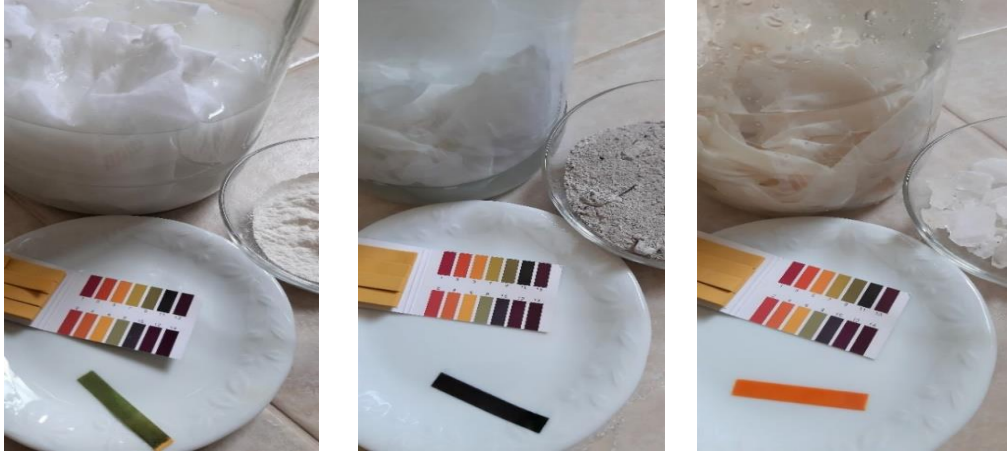
Resim 3.3. (solda) Pirinç unu çözeltisinin hazırlanması, pH değeri ölçümü, kumaşların mordanlanması Resim 3.4. (ortada) Kül çözeltisinin hazırlanması, pH değeri ölçümü, kumaşların mordanlanması Resim 3.5. (sağda) Şap çözeltisinin hazırlanması, pH değeri ölçümü, kumaşların mordanlanması
